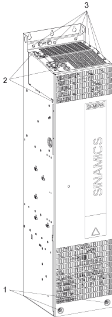
图 3-4 将制动模块安装到 FX 型功率模块中 – 步骤 1 - 3
